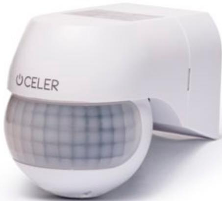
Detector de movimiento para pared. **Haz de detección de 180°**, distancia máxima 12 m, temporización y sensibilidad luminosa ajustables, para lámparas o luminarias LED, fluorescentes o convencionales.
